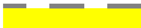
Bild 22: Der restliche Lack wird entfernt und dann wird das gewünschte Schaltbild auf die Scheibe aufgetragen.
